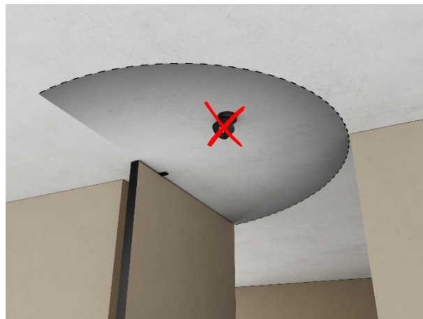
Rys. 2. Sprawdzenie czy nie ma przeszkód na suficie (lampy, alarmy i inne).
