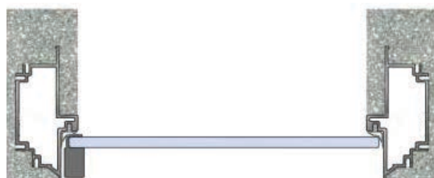
Rys. 2 – DRZWI ZLICOWANE ZE ŚCIANĄ, OTWIERANE NA ZEWNĄTRZ
