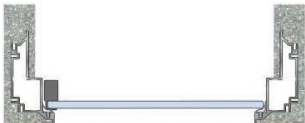
Rys. 1 – DRZWI ZLICOWANE ZE ŚCIANĄ, OTWIERANE DO ŚRODKA
