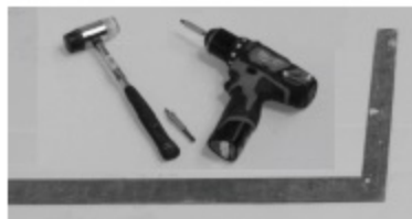
4. Narzędzia potrzebne do zmontowania ościeżnicy: - śrubokręt lub wkrętarka z bitem krzyżakowym (zalecany PH 2) oraz z bitem torx (TX20) - młotek
